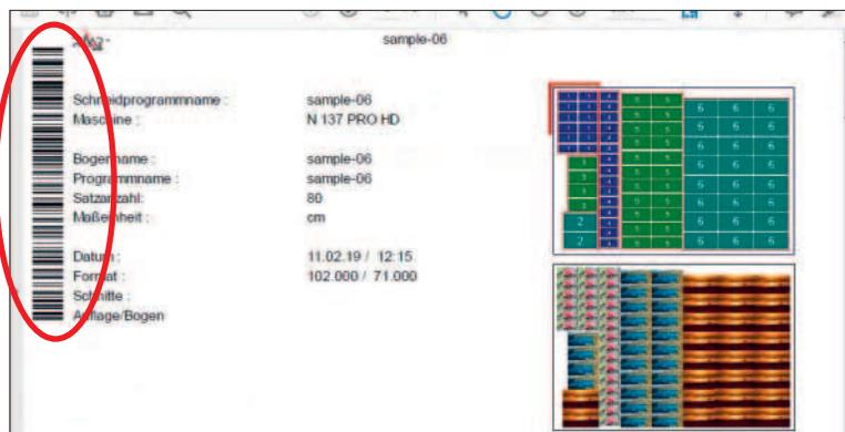
Nützlich ist die Funktion der Barcode-Erstellung aus Compucut. Mit einem ausgedruckten Barcode, der der Auftrags tasche beiliegt, lässt sich an der Schneidmaschine das jeweilige Programm aufrufen.
